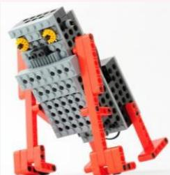
長い両腕を使って前に進むゴリラ型のロボットです。1回目はその場で腕立て運動を行うような動きとなります。
