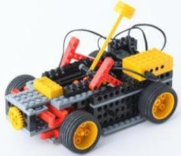
ステアリングを搭載し、カーブを描いて走ることができる車型ロボットです。ステアリングのジョイント部分にユニバーサルジョイントを使い、
