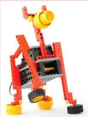
左右の足に取り付けるクランクの位置をずらし、4本の足の出るタイミングを変えて歩く馬型ロボットです。ポイントは「重心」の位置。頭の高さや足の長さを変えながらバランスを考えて安定して歩くロボットを作ります。
