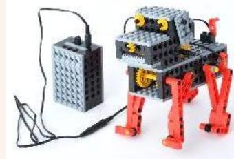
愛着がわくようなかわいらしい動きをする犬型ロボットです。二組のリンク機構により足の動きを生み出します。
