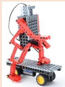
足で地面を蹴って進む、スケートボード型ロボットです。基本製作では右足のリンク機構により力強く蹴って前進する動きを実現します。さらに推進力を生み出すために左足や腕も同時に動くように改造します。
