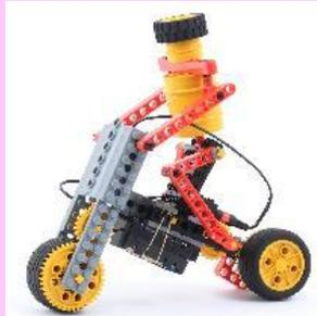
バランスを取りながら二輪で進む自転車型ロボットです。左右に非対称でも倒れずに進めるようなギアの組み合わせや全体のバランスを考えながら組み立てます。
