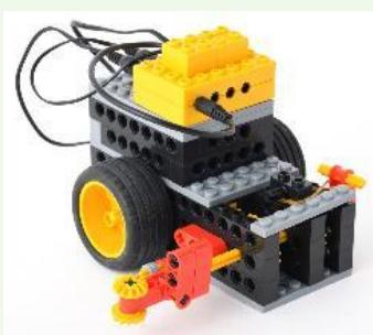
壁に沿って動く自動車型ロボットです。コーナーで壁から離れたときにギアの組み合わせが変わって曲がります。輪ゴムのかけ方や本数によりゴムの復元力が変わることを利用してスムーズなコーナリングを目指しましょう。
