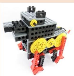
リンク機構によってつられた四本足をコミカルに動かしながら歩く大型ロボットです。ギアの回転の動きを前進させる足の動きに変換するリンク機構を学びます。足の取り付け方によってどのように動きが変わるか観察し、理解を深めましょう。
