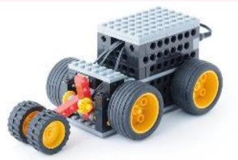
カブトムシ型のロボットです。手動でセンサーを操作し、ロボットを停止する機能を体感したうで、自動で停止できるようロボットに組み込みます。完成したら、オリジナルのカブトムシの改造にチャレンジしましょう！
