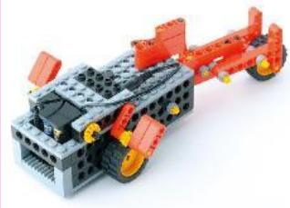
尾ヒレを左右に動かしながら進む、魚型のロボットです。モーターの動力はタイヤには伝わらず、尾ヒレを動かすだけですが、「ラチェット機構を使用することで、前に進めるように改造していきます。
