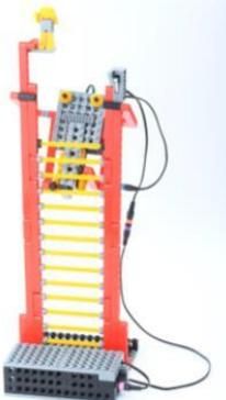
バランスを取りながら、はしごをのぼる消防隊をモチーフにしたロボットです。リンク機構で交互に足を動かしてのぼっていき、はしごの先では自動停止するよう安全面も工夫しています。
