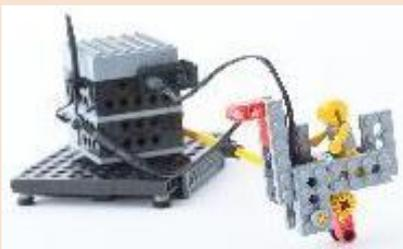
ぴよんぴよん跳ねながら前に進むロボットです。タッチセンサー黒、グレーのはたらきの違いやロボットに取り付けたおもりのバランスで動きが
