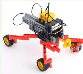
4本のキャスターがついたX型に組んだ足の動きでスムーズに進むロボットです。モーターの回転を足の開閉運動にどのように伝えるのか観察し、推進力を生み出す機構を理解しましょう。輪ゴムのかけ方やタイヤの向きもポイントです。
