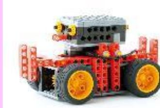
壁などにぶつかると、自動で逆方向に走り出す車型ロボットです。1回目の授業では、スライドスイッチを手動で操作しながらロボットの動きを観察し、2回目の授業
