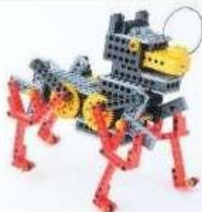
複雑な足の動きをリンク機構の組み合わせで実現した、四本足で歩く狼ロボットです。足の動きに加え、つま先やかかとの着くタイミングを観察しながら、前に進む仕組みを理解します。
