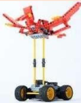
翼竜プテラノドンをモチーフにしたロボットです。台車を前進させるだけでなく、モーターの動力を翼に伝えて上下に羽をばたくような動きを生み出します。たくさんのロッドで作る翼のダイナミックな動きに注目です。
