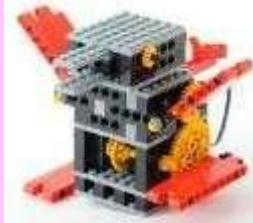
アヒルをイメージしたロボットです。平行に設置したリンクで構成し、足と床が平行に動くような機構でパタパタと歩く基本製作を行います。
