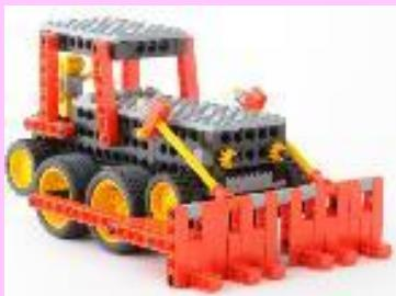
前面のブレードでものをかき分けながら強く進むブルドーザー型ロボットです。基本製作では車部分を作り、2回目にロッドをつなげてブレードを作ります。
