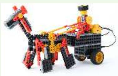
人馬一体となって進む馬車ロボットです。荷台に取り付けられたモーターの回転をシャフトやギアの組み合わせて様々な部分に伝えます。
