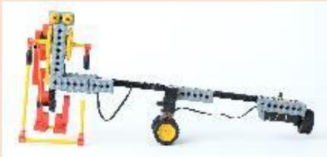
ゴムの復元力とおもりのバランスによって縄跳びをするロボットです。人がジャンプする動きを模した、足の伸び縮みを観察しながら、上手に縄跳びができるように作り上げましょう。左右のバランスがポイントです。
