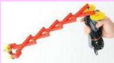
ギアの回転運動が「伸び縮み」する運動に変換される不思議さを体感できるつかむロボットです。ものをつかむ部分の構造を変えたり、ロッドのくり返し構造を追加してさらに長く伸びるようにします。パイロット救出ゲームなども行ない、楽しみ満載のロボットです。
