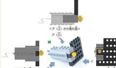
写真と図を見てモーターのセットを組み立てます。前から見たときに区別がつかないパーツも横から見ると、どのパーツなのか確定させることができます。
