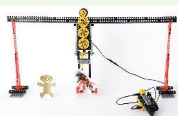
1つのモーターの正転・逆転だけで、「レールの上を移動する」、「ものをつかむ・はなす」という動作ができるロボットです。前半でハンド部分を作成し、後半でレールの上を
