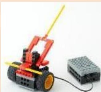
相手を見つけると竹刀を振る剣道ロボットです。目の前の障害物に当たると竹刀を振る仕組みとして、スライド式のロック解除装置を製作します。自動で振る仕組みを理解して強いロボットに改造しましょう。友だちや先生との対決を楽しんでください！
