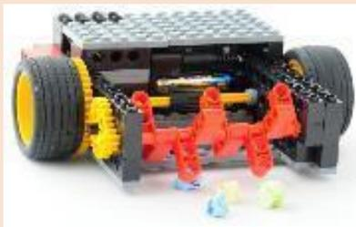
小さなものを拾い集める掃除機ロボットです。先端のローラーを回転させごみを取り込みます。
