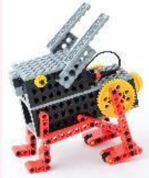
愛嬌のあるデザインのウサギ型ロボットです。基本製作の後には、前後の足が連動して動くように改造します。さらに後ろ足の取り付け方を変えることで意外な動きになることにも注目してください。色々なウサギをイメージした改造もお楽しみに。
