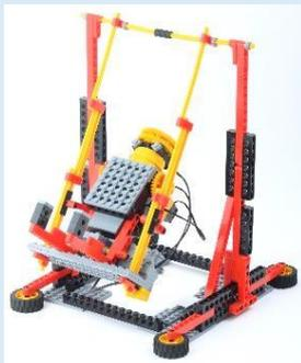
座り漕ぎするロボットに改造します。ブランコの揺れに合わせて上半身を前後に動かします。安定して漕ぎ続けられるように、モーターの出力と時間を調整するだけでなく、光センサーを使った制御がポイントです。
