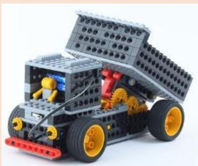
荷台を上下させるダンプ型ロボットです。スイッチを入れると前進し、停止すると同時に荷台を持ち上げます。
