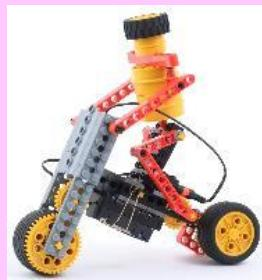
バランスを取りながら二輪で進む自転車型ロボットです。左右に非対称でも倒れずに進めるようなギアの組み合わせや全体のバランスを考えながら組み立てます。
