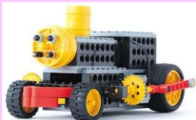
蒸気機関車のピストンの動きを再現したロボットです。ロボットが前に進むと、左右に付いたピストン（ギア）が前後に往復運動します。さらに、荷物を積む台車（石炭車）を追加する改造も行います。
