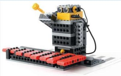
2つのモーターを使い、腕を振る動作で木琴の演奏を再現するロボットです。1回目は基本製作で、腕を振る動作に合わせて音を鳴らします。2回目は木琴を作り、もう1つのモーターで移動しながら木琴をたたくように改造します。
