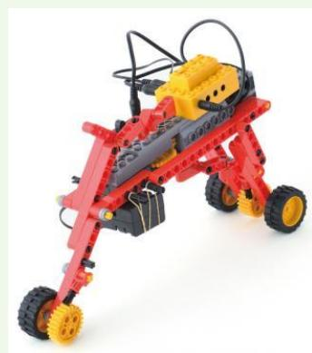
足の前後運動を作り出し、シャクトリムシのように前進するロボットです。モーターの回転運動を、リンク機構により足の前後運動に変換できる学びます。さらにラチェット機構を組み込むことで前進できるように作り上げます。
