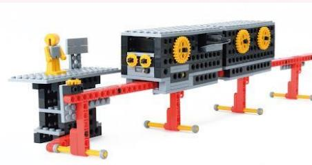
レールの上を進むモノレール型のロボットです。モーターの動力を後輪のタイヤに伝え、レールをはさみながら車輪との摩擦によって前に進みます。さらにレールの端にきたら自動停止する仕組みも組み込みます。
