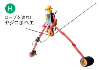
基本製作ではロープウェイ、応用実践ではサーカスの綱渡りのような動きを するロボットを作ります。ギアの回転を利用して綱を渡ります。バランスを とって綱を渡れるように「やじろべえ」を参考にしながら調整を行い、物体の 重心について学びます。
