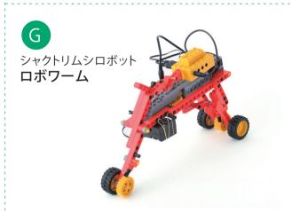
足の前後運動を作り出し、シャクトリムシのように前進するロボットです。 モーターの回転運動を、リンク機構により足の前後運動に変換できることを 学びます。さらにラチェット機構を組み込むことで前進できるように作り上げ
