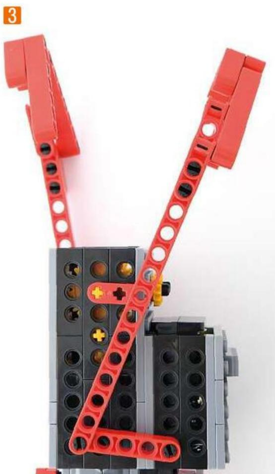
プレートLとしっぽを元にもどします。クランクは（シャフト・ロッド）を中心にかいてん回転し、つながっているロッド15アナ（うで・手）を動かす。先んたんのロボットの（うで・手）を前後に動かします。
