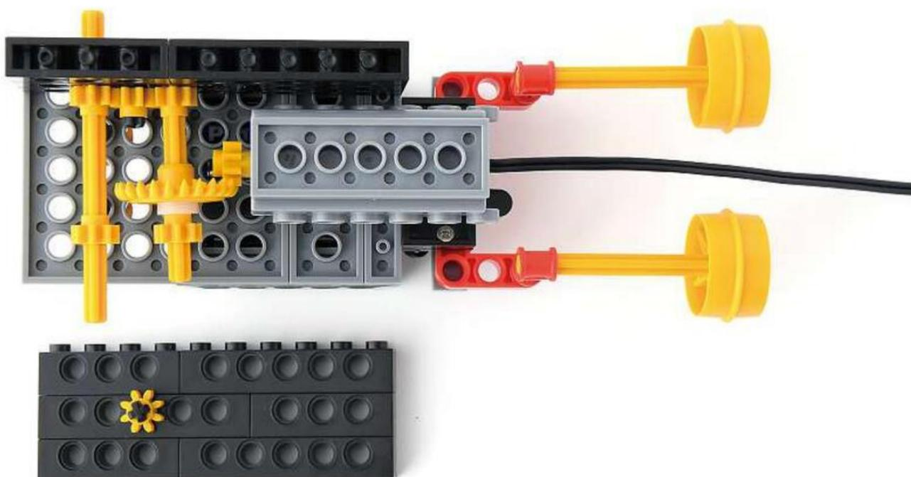
**6** 側面を取り付け、プレートでふたをします。
