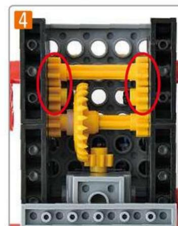
基本の形のロボットのギアの組み合わせと、改ぞうしたロボットのギアの組み合わせのこと
