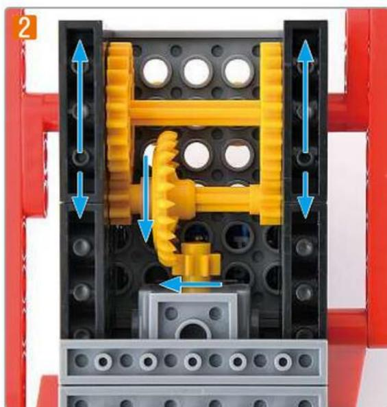
ロボットの背中のプレートLを外して、タッチセンサー黒で少しずつ動かしながらギアボックスとうでを観察しましょう。
