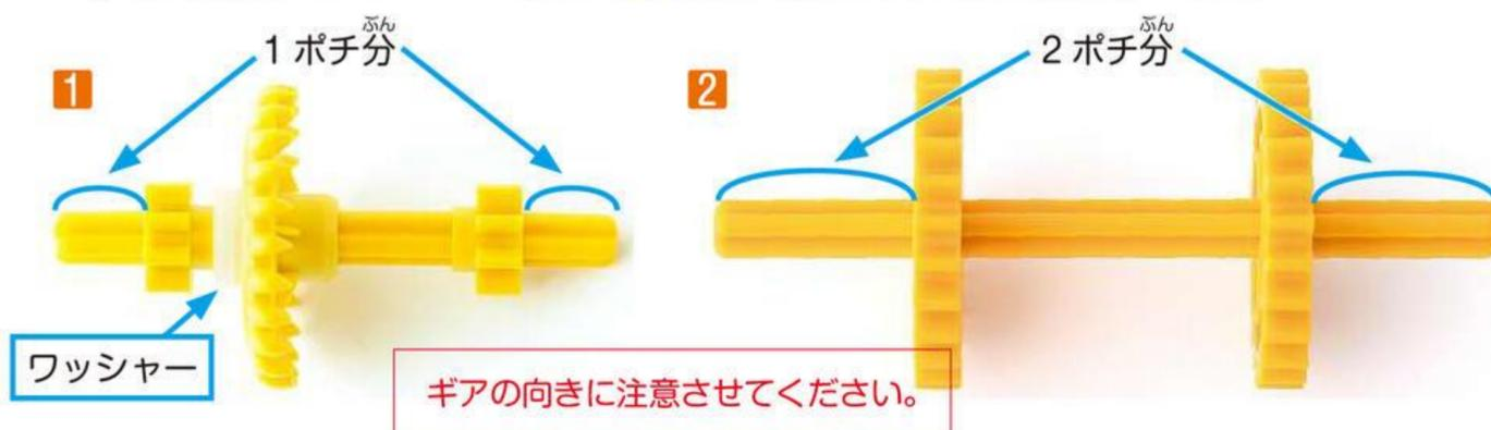
**5** 4のギアのセットを側面に取り付け、太プレート6ポチの上にモーターのセットを取り付けましょう。
