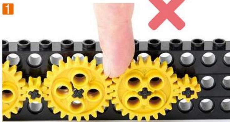
回転するギアに、長い髪の毛などが巻き込まれないように、気を付けてください。髪の毛の長い生徒には、ロボットを製作する時に、髪の毛を留めたり結んだりするように伝えましょう。
