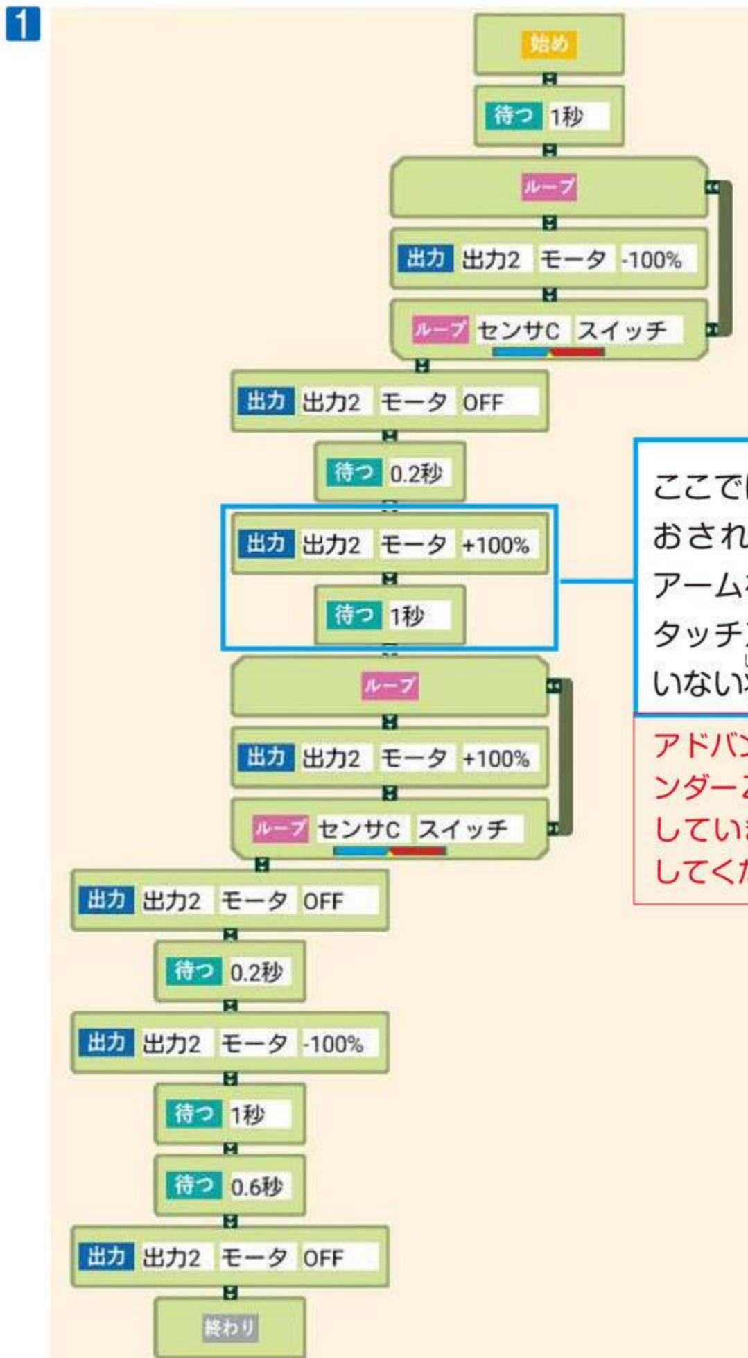
図1のプログラムは一例です。 出力2：アームのモーター センサC：タッチスイッチ
