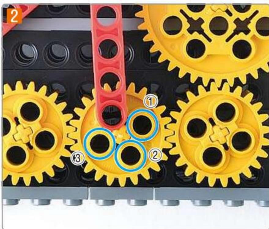
写真の①、②、③の位置にペンホルダーのロッド9アナのペグを付けかえて、ロボットを動かしましょう。
