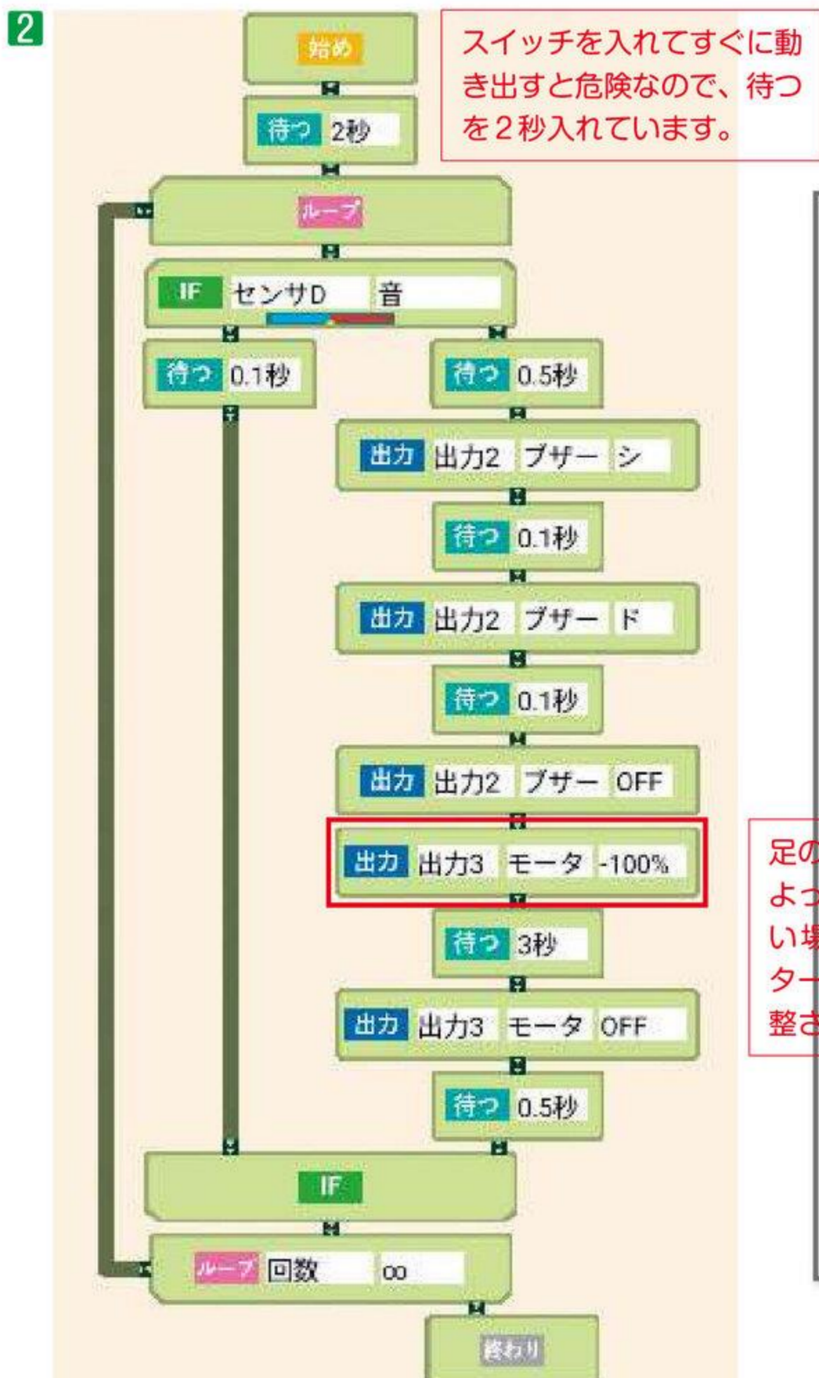
図2のプログラムは一例です。 出力2:ブザー 出力3:モーター センサD:音センサー
