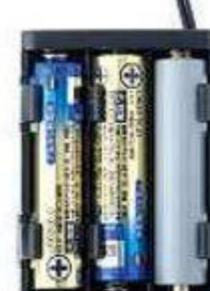
4 ③のバッテリーボックス／スライドスイッチを取り付けましょう。コードは、バッテリーボックスの下にならないように、写真のようにすみに入れます。
