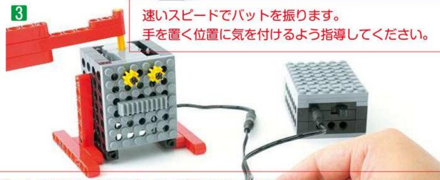
バットを振る力が強くバッターが動いてしまう場合は、タッチセンサーを一瞬だけ押して、バットを振ったらすぐ止まるように操作するよう、指導してください。また、置く場所によってもバッターが動いてしまう場合がありますので、2日目に改造して動かないような工夫をするよう指導してください。
