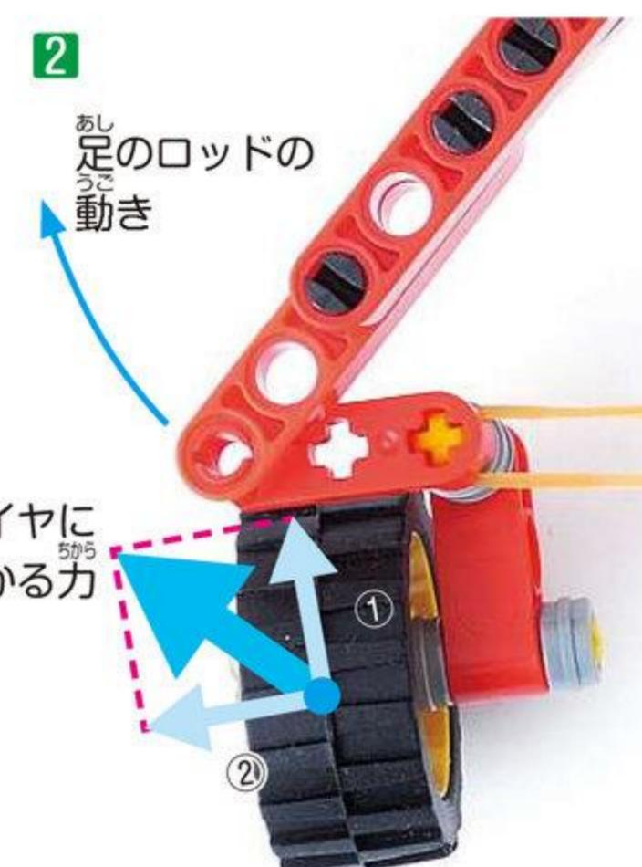
太矢印←で表示した力は、足のロッドを広げる力を表します。この力は、ロッドが回転運動をするのでロッドに対して直角（回転運動=円の接線方向）に働きます。その力をタイヤが回る方向（①）と回らない方向（②）に分けています。分けられた力を分力と言います。
