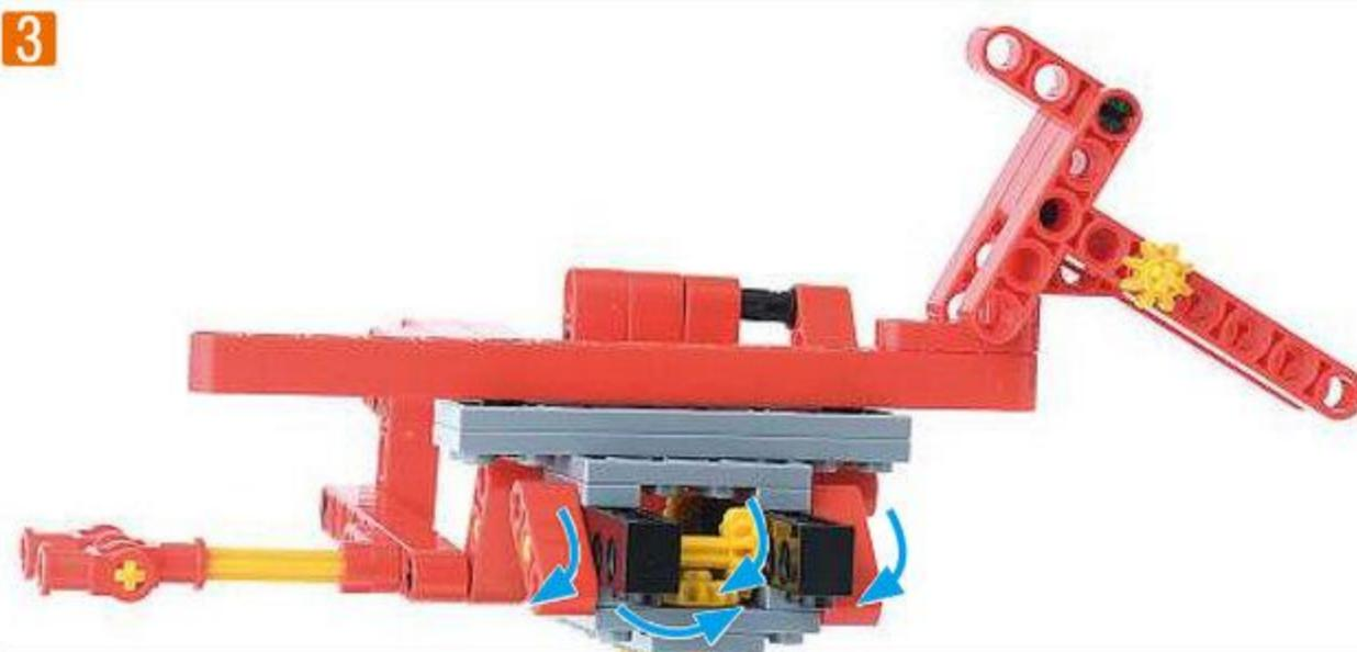
③縦のシャフトの回転がプロトロボットのマイタギアを回転させます。
