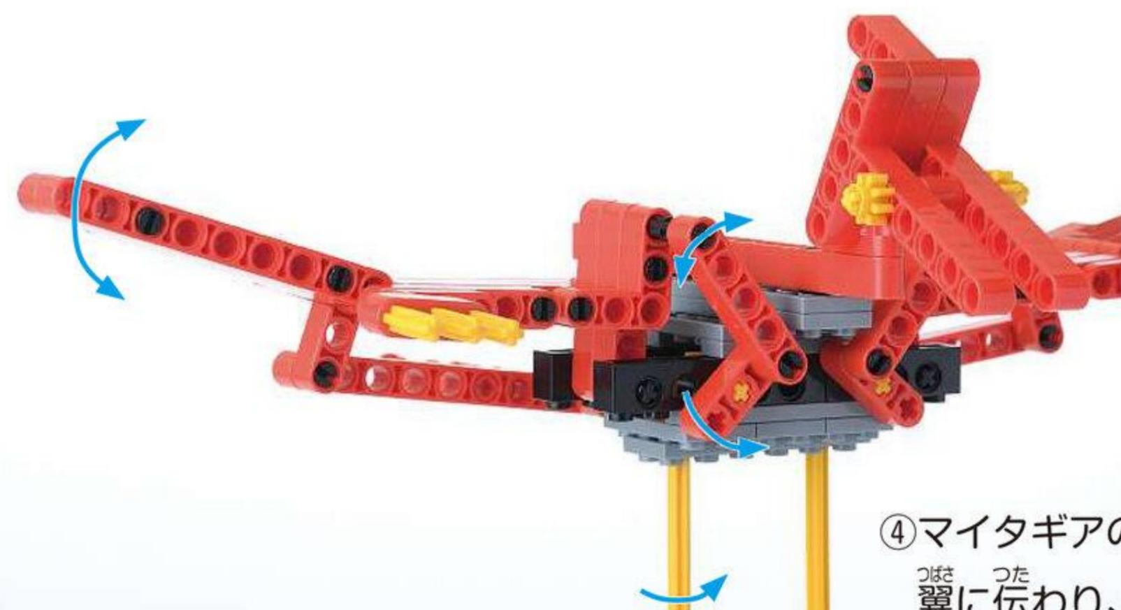
④マイタギアの回転がロッドでつながった翼に伝わり、翼を動かします。
