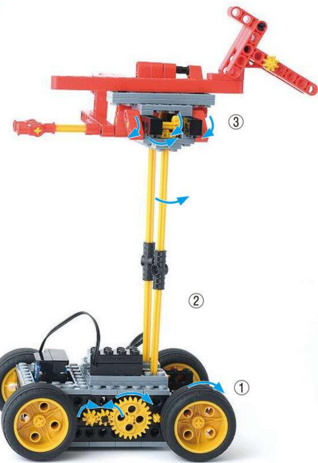
①スイッチを入れると、モーターの回転が台車の側面にあるギアを伝わり、タイヤを回転させます。
