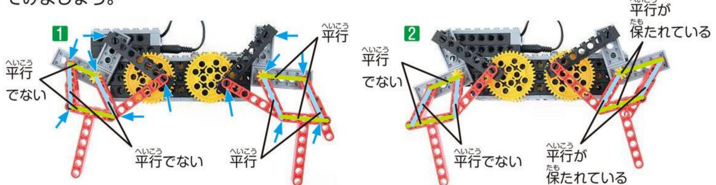
む 向かい合うリンクの長さが同じである後ろ足は平行が保たれて安定した動きを生み出します。これを平行リンクと呼びます。
