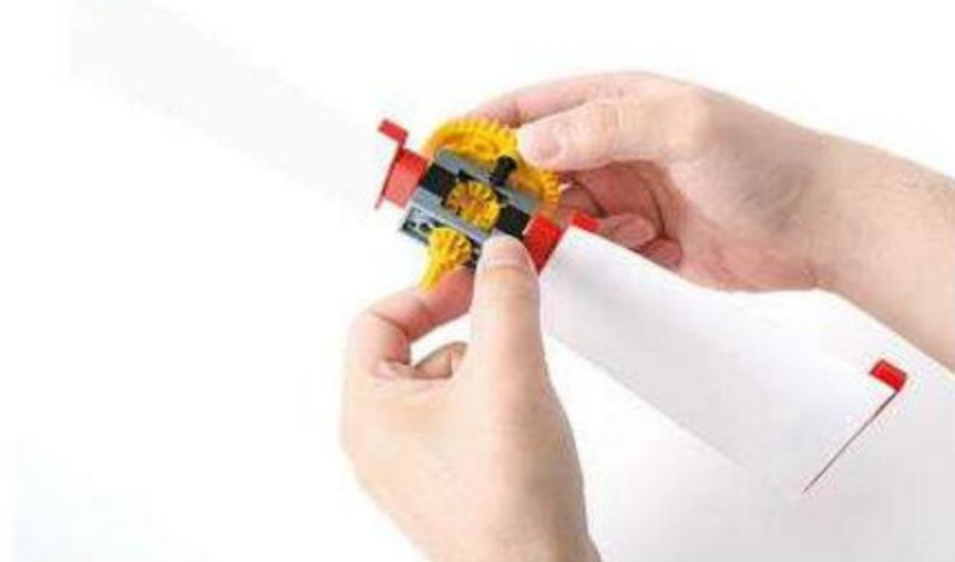
プロペラの向き、ギアのシャフトペグの位置に注意して組み立てます。
