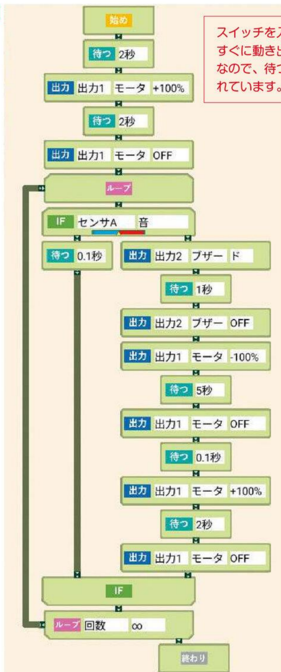
図1のプログラムは一例です。出力1：モーター 出力2：ブザー センサA：音センサー
