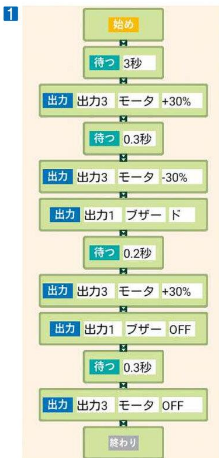
図1のプログラムは一例です。 出力1：ブザー 出力3：うでを動かすモーター
