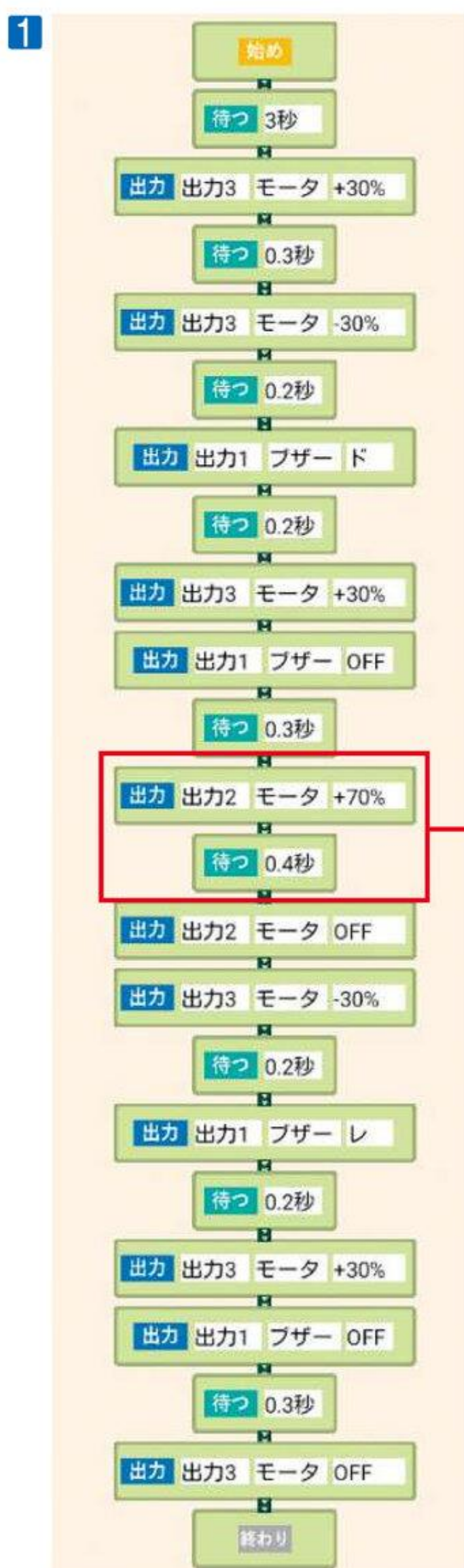
図 1 のプログラムは一例です。 出力1：ブザー 出力2：横移動するモーター 出力3：うでを動かすモーター
