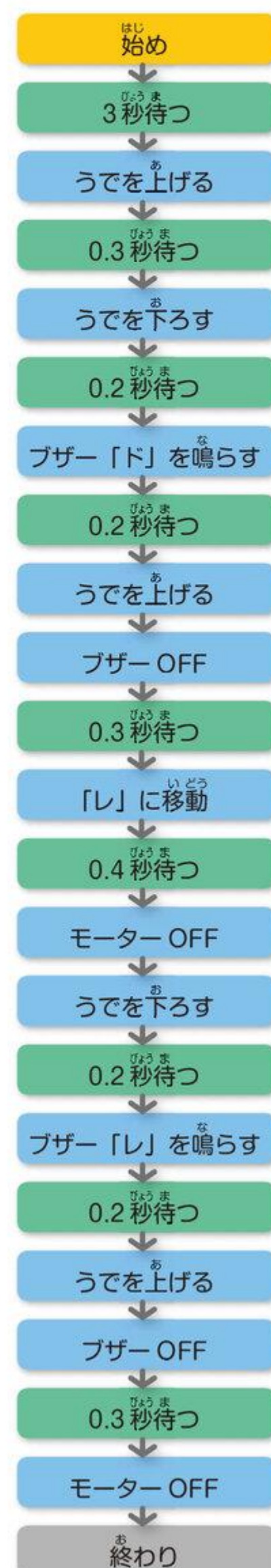
図 1 のプログラムは一例です。 出力1：ブザー 出力2：横移動するモーター 出力3：うでを動かすモーター
