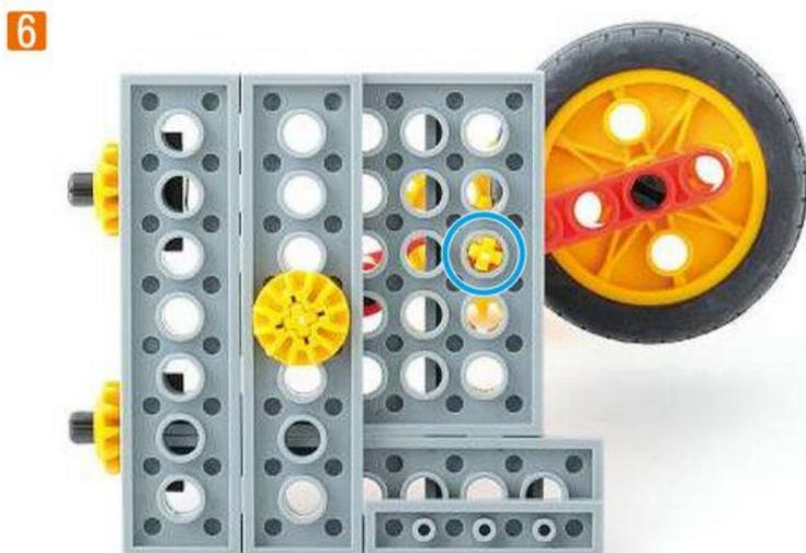
治具を使うことで、タイヤの位置をロボットが最も安定して歩く位置に固定することができます。そのためにも、ギアLとロッド9アナの位置を写真**3**に合わせておくことが重要です。
