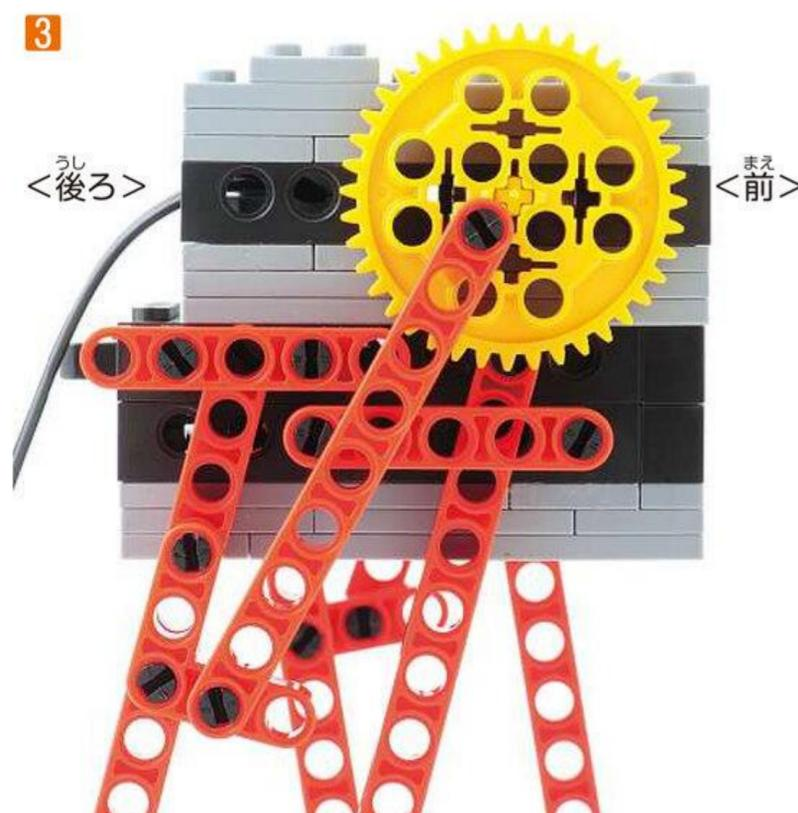
ロボットの左側（写真2）では、ギアLの中心（シャフトのあな）からみて前の上のあなに入れてあります。ロボットの右側（写真3）は、ギアLの中心からみて後ろの下のあなに入れてあります。
