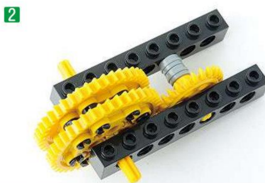
<使用パーツ>ビーム8ポチ×2、ギアL×2、ペグS×4、シャフトペグ×4、ベベルギア×1、ブッシュ×2、シャフト6ポチ×1、シャフト4ポチ×1
