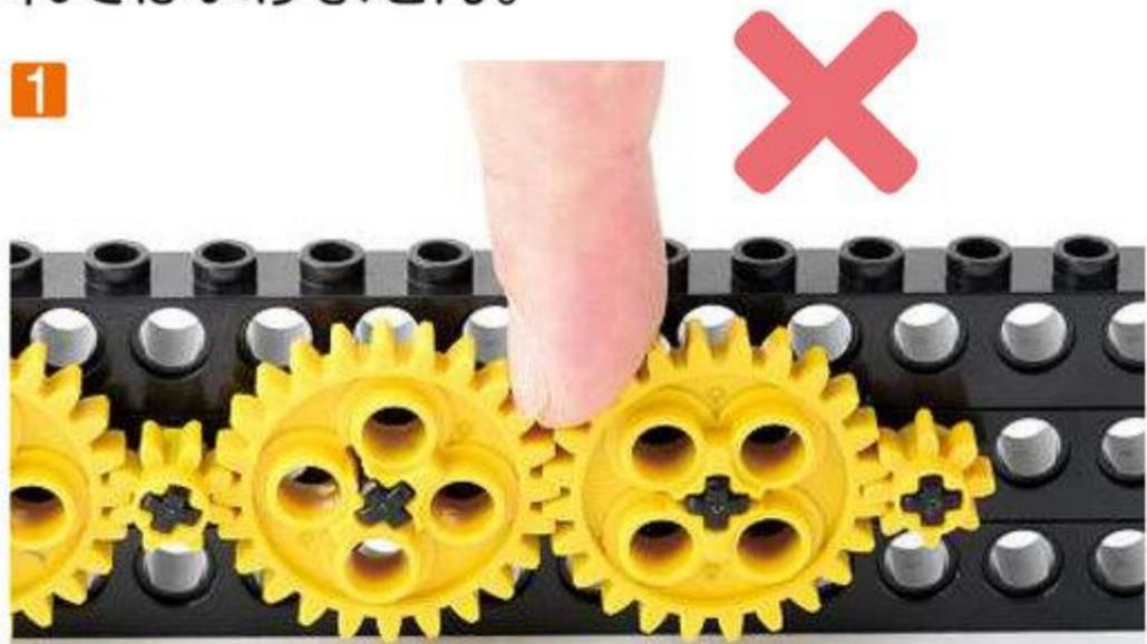
回転するギアに、長い髪の毛などが巻き込まれないように、気を付けてください。髪の長い生徒には、ロボットを製作する時に、髪の毛を留めたり結んだりするように伝えましょう。
