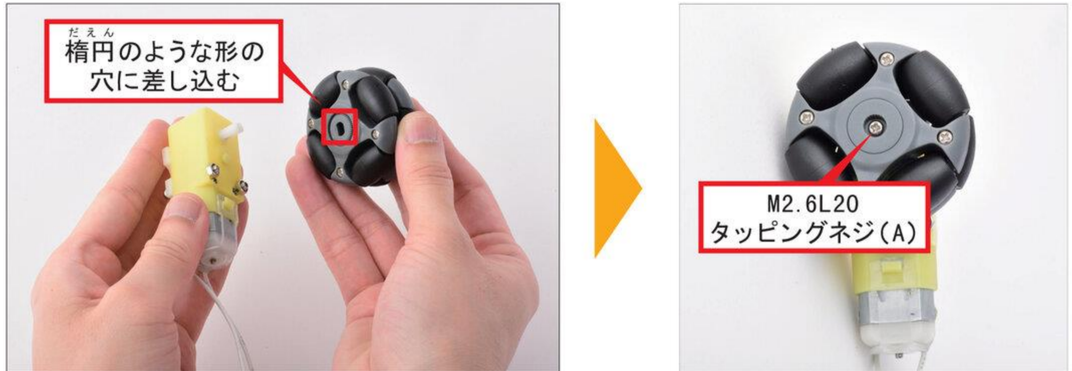
図1-3 ギアドモーターとオムニホイールの組み立て
