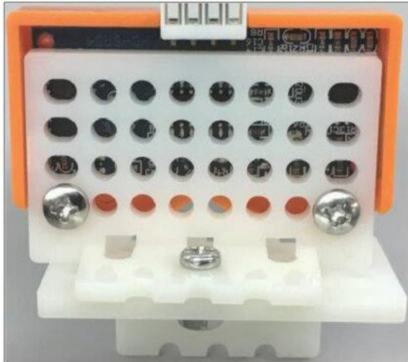
図1-2 超音波距離 ちようおんばきより センサーとセンサーL字ステイの取り付け例
