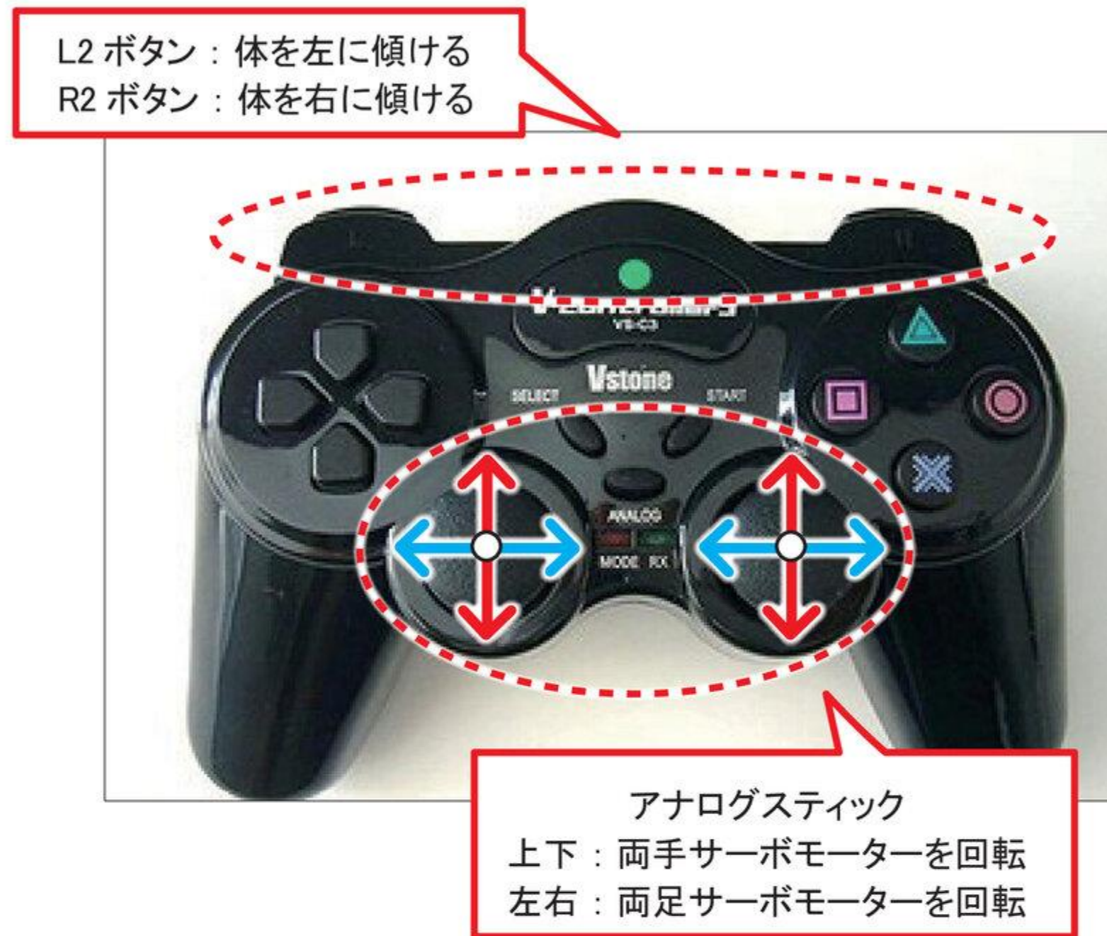
図1-0 サーボモーターの操縦方法 そうじゅう
