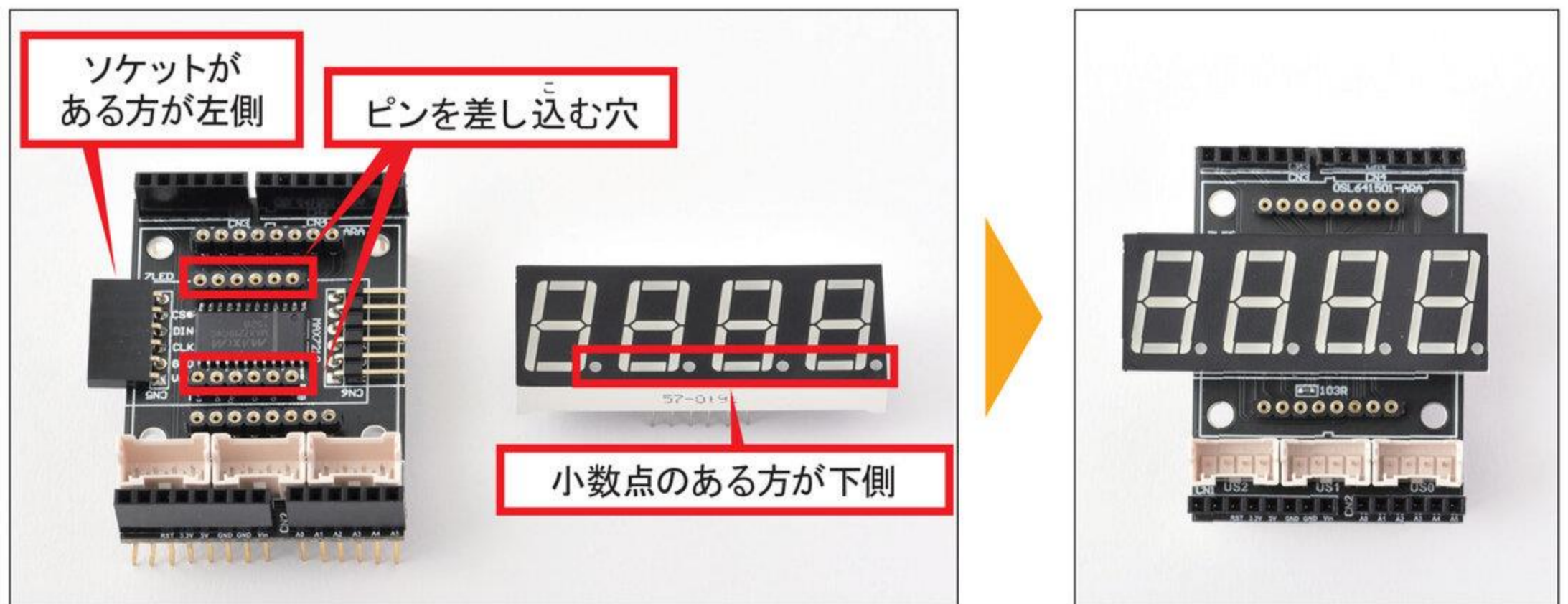
図1-2 7セグメントLEDとマトリクスLEDシールドの組み立て
