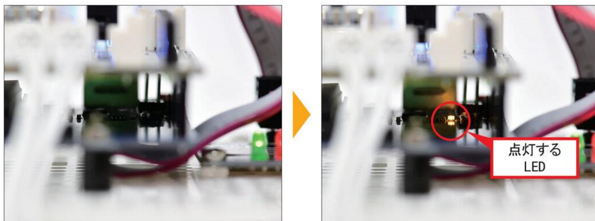
図 1-6 タッチセンサーの反応により点灯する LED
