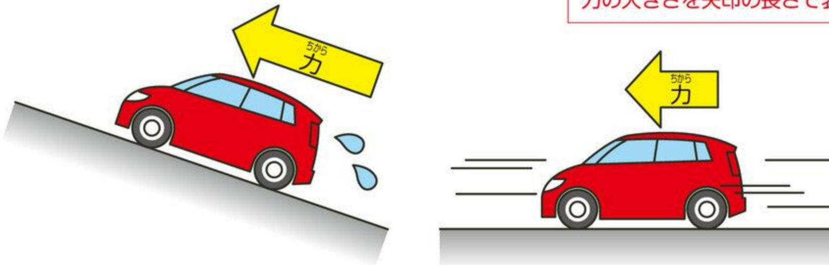
このように自動車は、その時のじょうきょうによって、走り方を変える必要があります。そのため、トランスミッション（変速機）というそうちでギアの組み合わせ方を変えて、エンジンのパワー（動力）をコントロールしてタイヤに伝えています。
