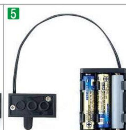
4 ③のバッテリーボックス／スライドスイッチを取り付けましょう。コードは、バッテリーボックスの下にならないように、写真のようにすみに入れます。
