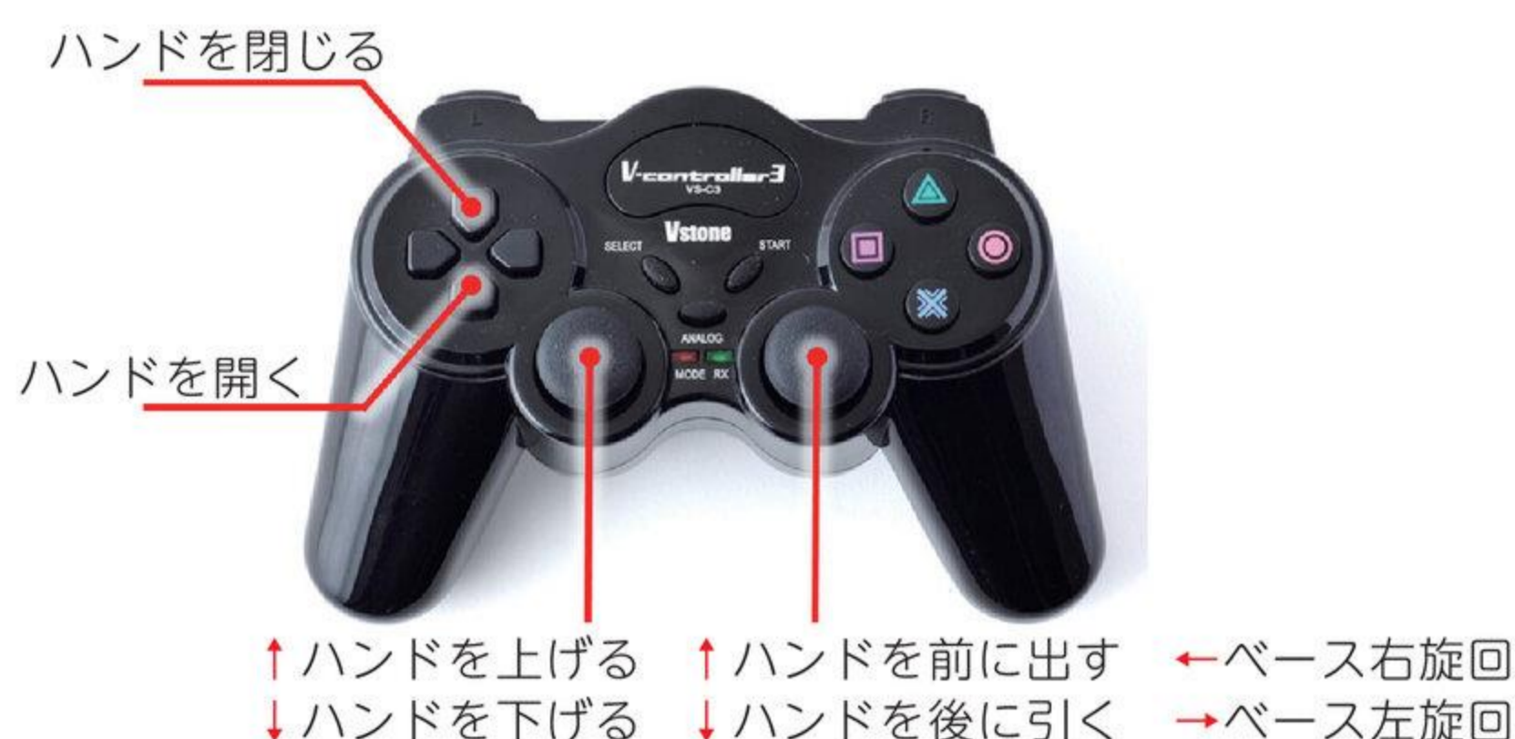
図 2-3 「semiAutoArm」のコントローラーの操作方法
