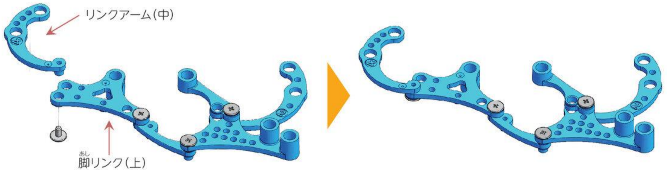
図1-4 リンクアーム(中)の取り付け
