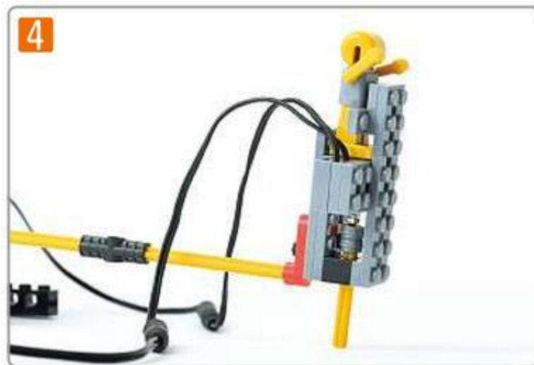
モーターの回転によりぴよんぴよんマシンが下向きにおされる
