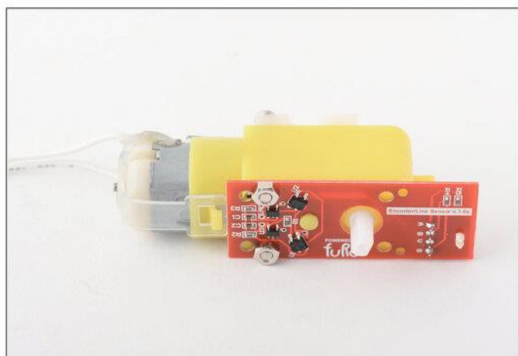
図 1-8 エンコーダ基板の組み付け (左モーター)
