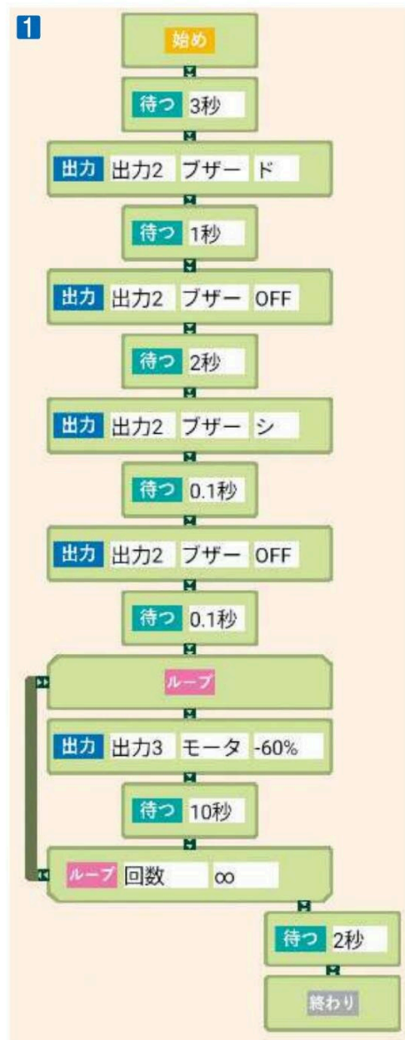
図1のプログラムは一例です。 出力2：ブザー 出力3：体を上下に動かすモーター
