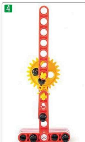
2本のシャフトベグの位置が写真の通りになるように、ギアのセットとロッドを取り付けてください。
