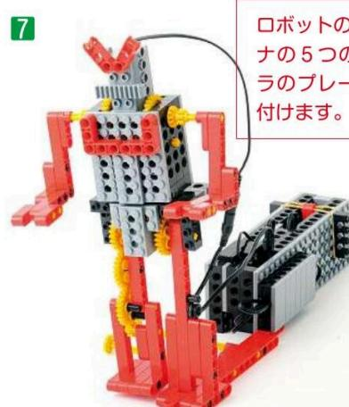
ロボットの左足のロッド15アナの5つの穴に、コントローラのプレートLのポチを取り付けます。
