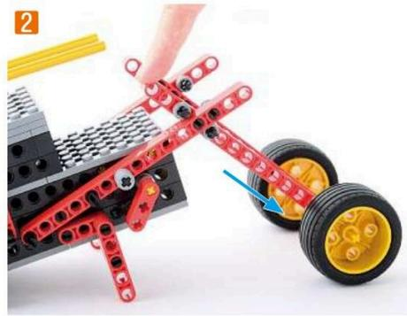
写真1の時、タイヤLは、上の方向へ引っばられるため、タイヤLと地面との間の摩擦力が（大きく・**小さく**）なります。
