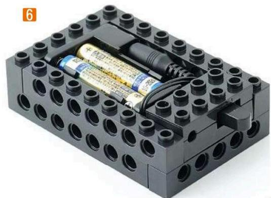
底にプレートが付いていないので、動かす際に、バッテリーボックスを落とさないように注意してください。
